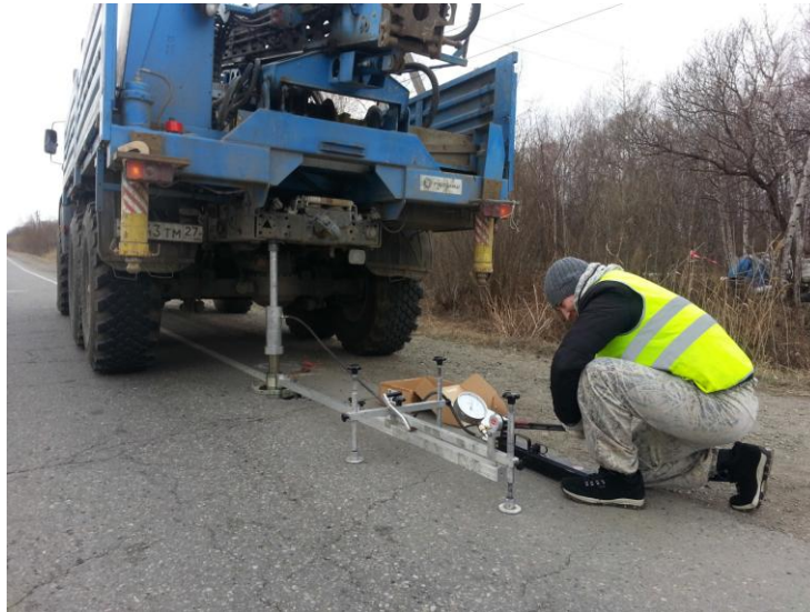
Рис. 1 – Статическое нагружение штампа фирмы «Tasting»
