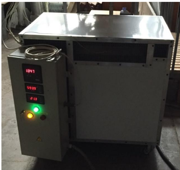
Рис. 1 – Теплоаккумуляционный электроотопительный прибор для животноводческих помещений
