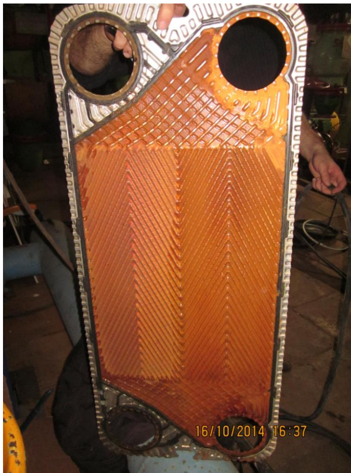
Рис. 1 – Пластина теплообменного аппарата
