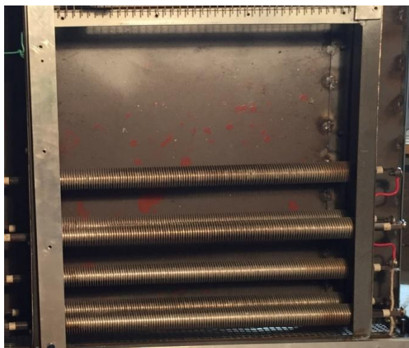
Рис. 2 – Электроконвектор прямого нагрева
